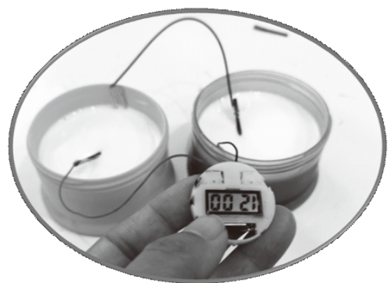
第三關「食物發電」，學生利用牛奶作為電解質，筆芯(石墨)作為正極，迴紋針作為負極，進行發電。
